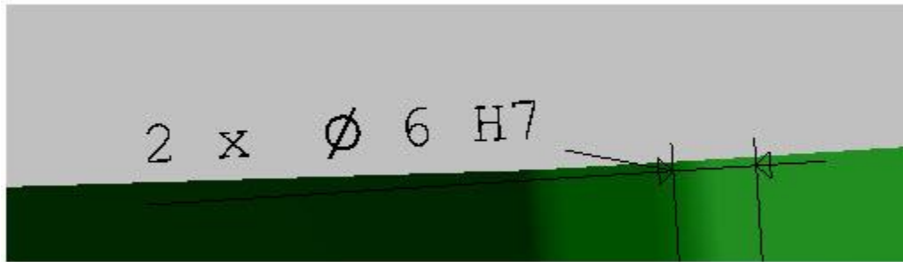
Esempio di tolleranze ISO in un grafico di PC-DMIS
